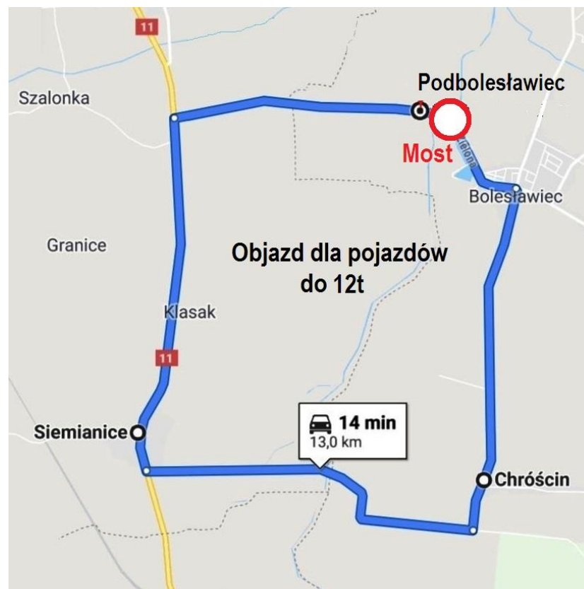
Rys. GPI-POR/57/2019- 02 Ogólny zarys objazdów z rozdzieleniem nośności powyżej j i poniżej 12t z odległościami i czasem przejazdu wg Mapy Google
